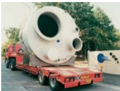
Séparateur humide pour fabrication d'engrais.
